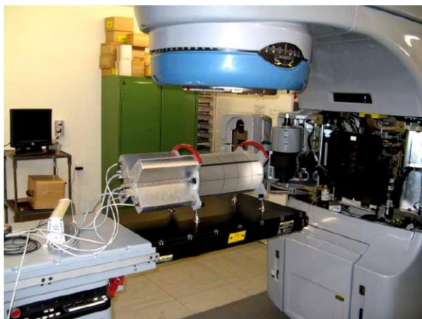
Obr. 25: Verifikace RapidArc ozařovacích plánů 3D maticovým detektorem.
