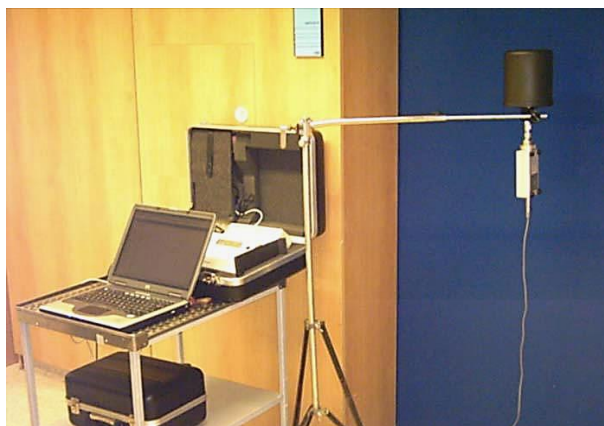
Obr. 7: Monitorování kerry ve vzduchu za stíněnými dveřmi radioterapeutické ozařovny.
