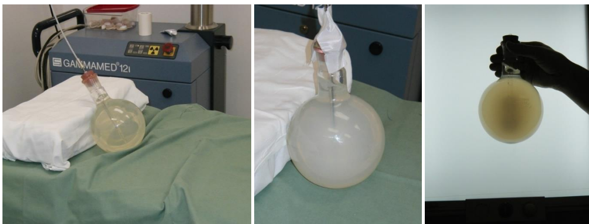
Obr. 45: Dozimetrická verifikace ozařovacího plánu v brachyterapii prováděná pomocí polymerové gelové dozimetrie.
