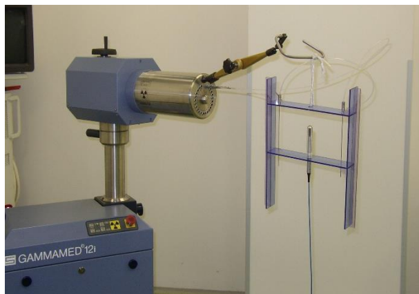
Obr. 44: Měření kerry ve vzduchu Farmerovou ionizační komorou u brachyterapeutického afterloadingového přístroje Gammamed.
