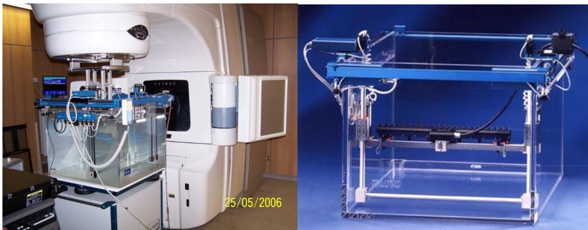
Obr. 11: Měření základních charakteristik svazku (profily svazku a hloubkové dávkové křivky) ve skenovacím vodním fantomu prostřednictvím lineárního pole ionizačních komor (chamber array).
