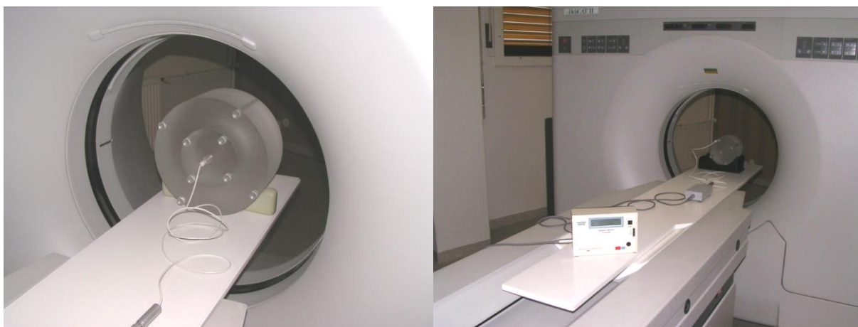
Obr. 14: Modulární cylindrický fantom pro kontroly CT simulátorů umožňuje simulovat trup nebo hlavu pacienta.
