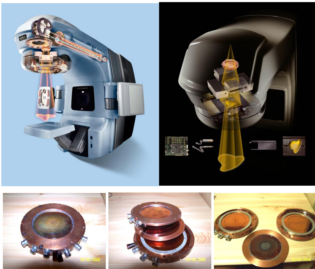
Obr. 5: Umístění (nahore) a vnitřní uspořádání (dole) dusíkem plněné monitorovací ionizační komory.
