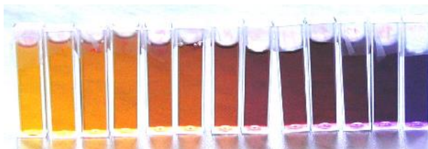
Obr. 38: Radiochromické dozimetry Fxo(B) ozářené různě velkou dávkou rostoucí zleva doprava.
