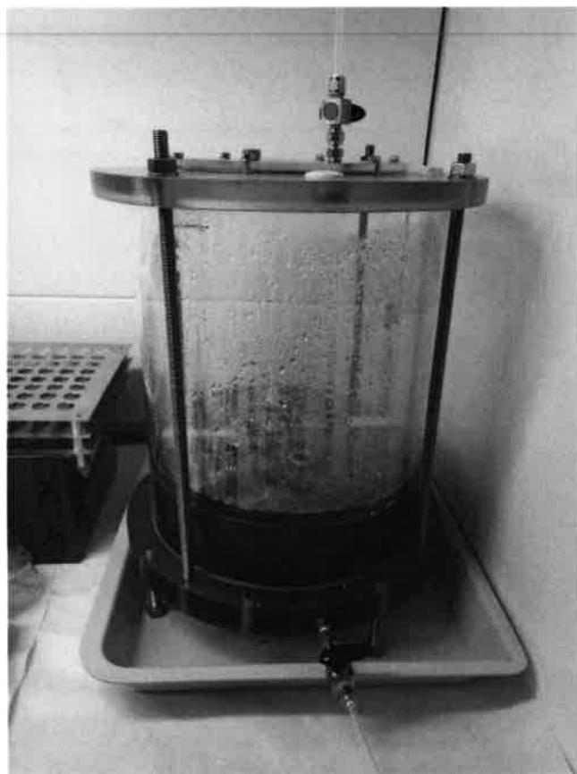
Fotodokumentace sestavy pro uskutečnění aktivních laboratorních experimentů středního měřítka. Utěsněná sestava umístěná v digestoři. Sestava je opatřena výpustním a odvzdušňovacím kohoutem.
