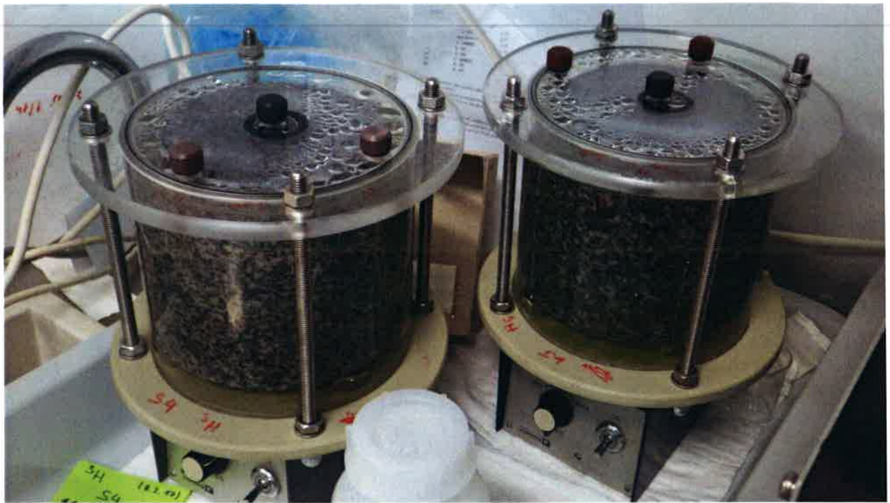
Fotodokumentace sestavy pro uskutečnění aktivních laboratorních experimentů středního měřítka. Utěsněné sestavy umístěné v digestoři s mícháním roztoku pod vzorkem. Okolí zdrojového vrtu je utěsněno proti případné kontaminaci okolního roztoku.
