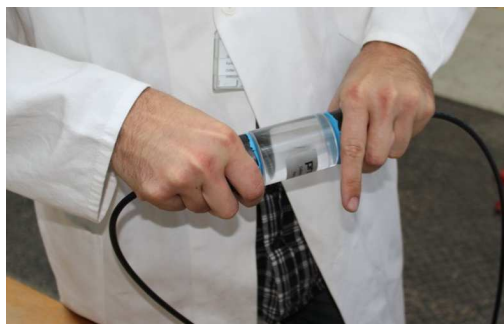
Obr. 2 Kalibrace přístroje PUNDIT PL pomocí etalonu
