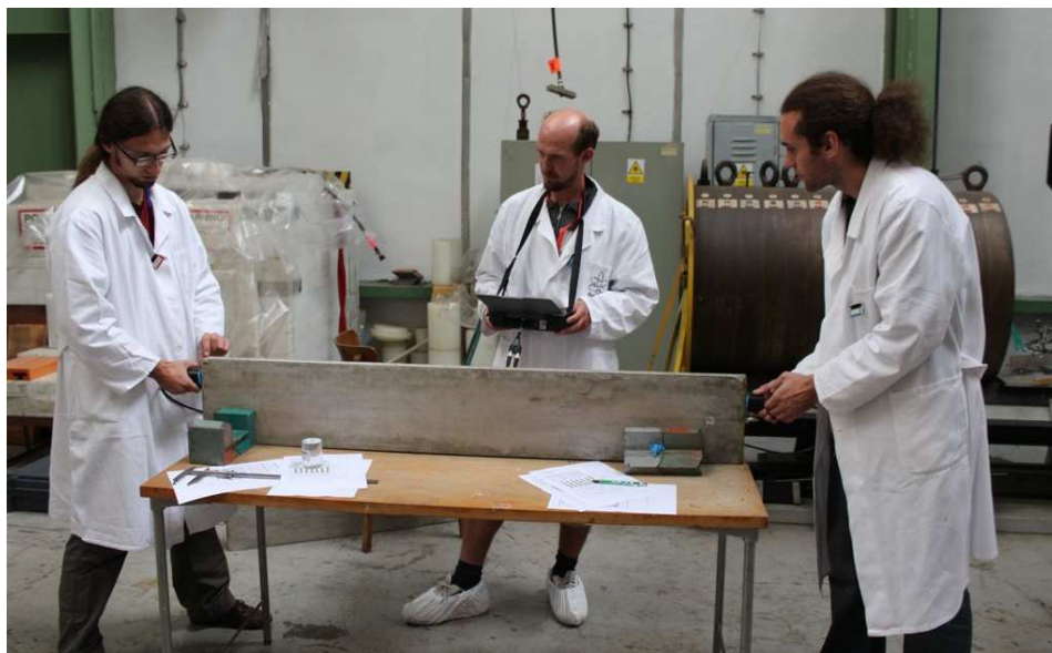
Obr. 11 Měření doby průchodu v horní části desky T2 v jejím podélném směru
