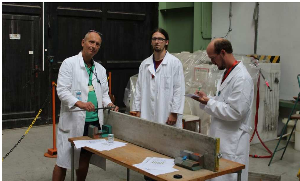
Obr. 6 Měření příčného rozměru desky betonu biologického stínění pomocí posuvného měřítka
